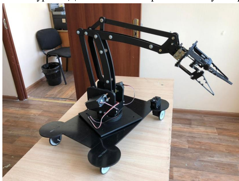
2.11 – сурет - Роботталған арбадағы біз жинаған робот-манипулятор
